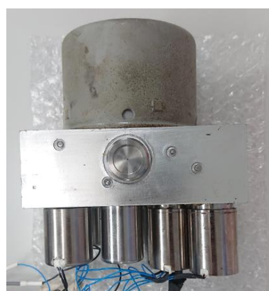
圖四 比例液壓煞車作動器總成實體
