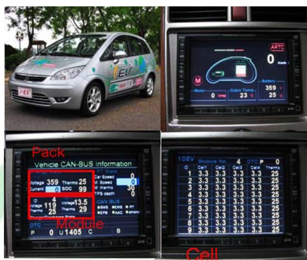
圖 4 中心開發之電動車 i-EV 與車端顯示器顯示電能資訊
