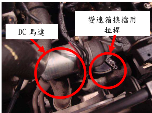
圖6 直流有刷馬達與變速箱搭配
