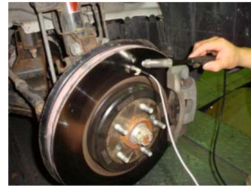
圖 3 靜態測試實驗架設圖 (on car)
