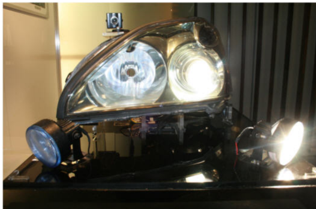
圖說：圖為影像式適應性頭燈轉彎之狀況, 系統利用攝影機 (左上角) 偵測辨識道路轉彎狀況即時轉動頭燈, 照亮彎路的方向, 讓駕駛者可以把道路狀況看清楚。
