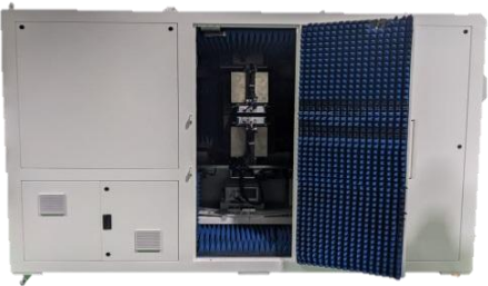
雷達模擬測試：將測試情境之障礙物訊號以RTS模擬，再用雷達進行系統測試
