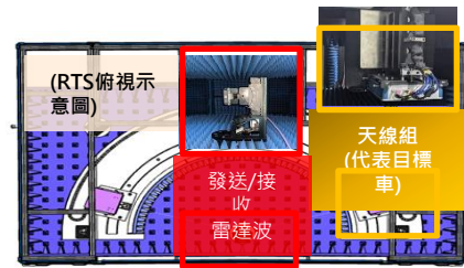
雷達模擬測試：將測試情境之障礙物訊號以RTS模擬，再用雷達進行系統測試
